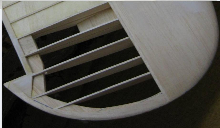
So sieht eine Tragflächenhälfte nach dem Bespannen aus. Über die Rippen wurden noch selbstgeschnittene Nahtbänder gelegt.
