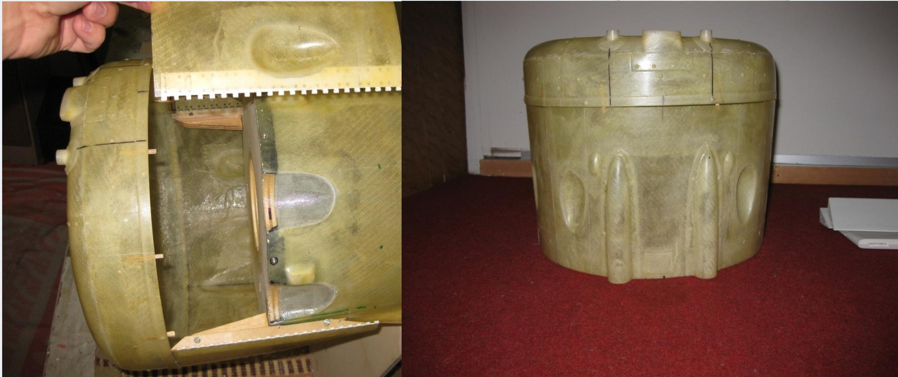
Damit man bei montiertem Propeller an den Motor herankommt, sind eine Reihe Scharniere eingebracht, die mit einem langen Draht verbunden werden. So lässt sich der hintere Teil halbseitig öffnen und Aufklappen, oder ganz abnehmen. Vorteil: die Haubenbefestigung zum Rumpf ist unsichtbar.
