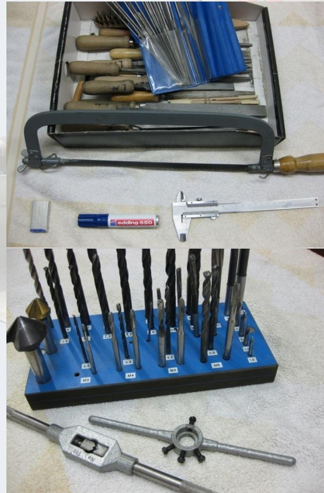
Zunächst wird das zu bearbeitende Material mit Edding gefärbt, danach mit einer Reißnadel (spitz geschliffener Federstahldraht) die Teilekontur gemäß Skizze angerissen. Dies ergibt einen guten Kontrast und eine exakte Orientierung für die folgende Bearbeitung.
