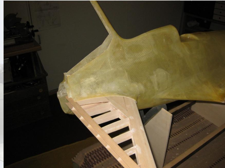
Die Vollsymmetrischen Leitwerksteile wurden in zwei Hälften auf einer ebenen Unterlage aufgebaut und dann spiegelbildlich zusammengeklebt. Für den Einbau in den Rumpf wurde wegen unstimmig ausgeführter Anformungen und eines zu groß dimensionierten Seitenleitwerks schon mal einiges an Laminat herausgetrennt.
